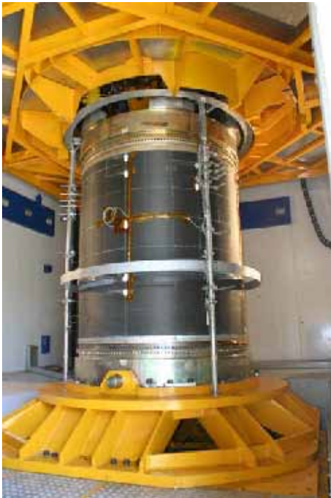
Essais Mécaniques structure Z23
