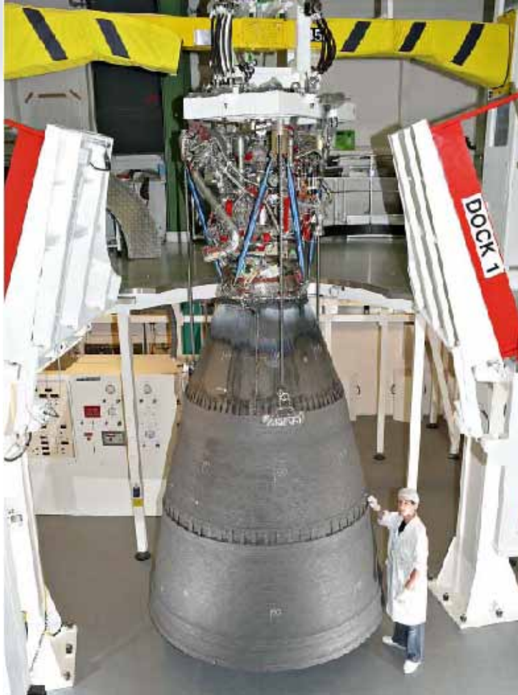
Moteur Vinci à divergent déployable
