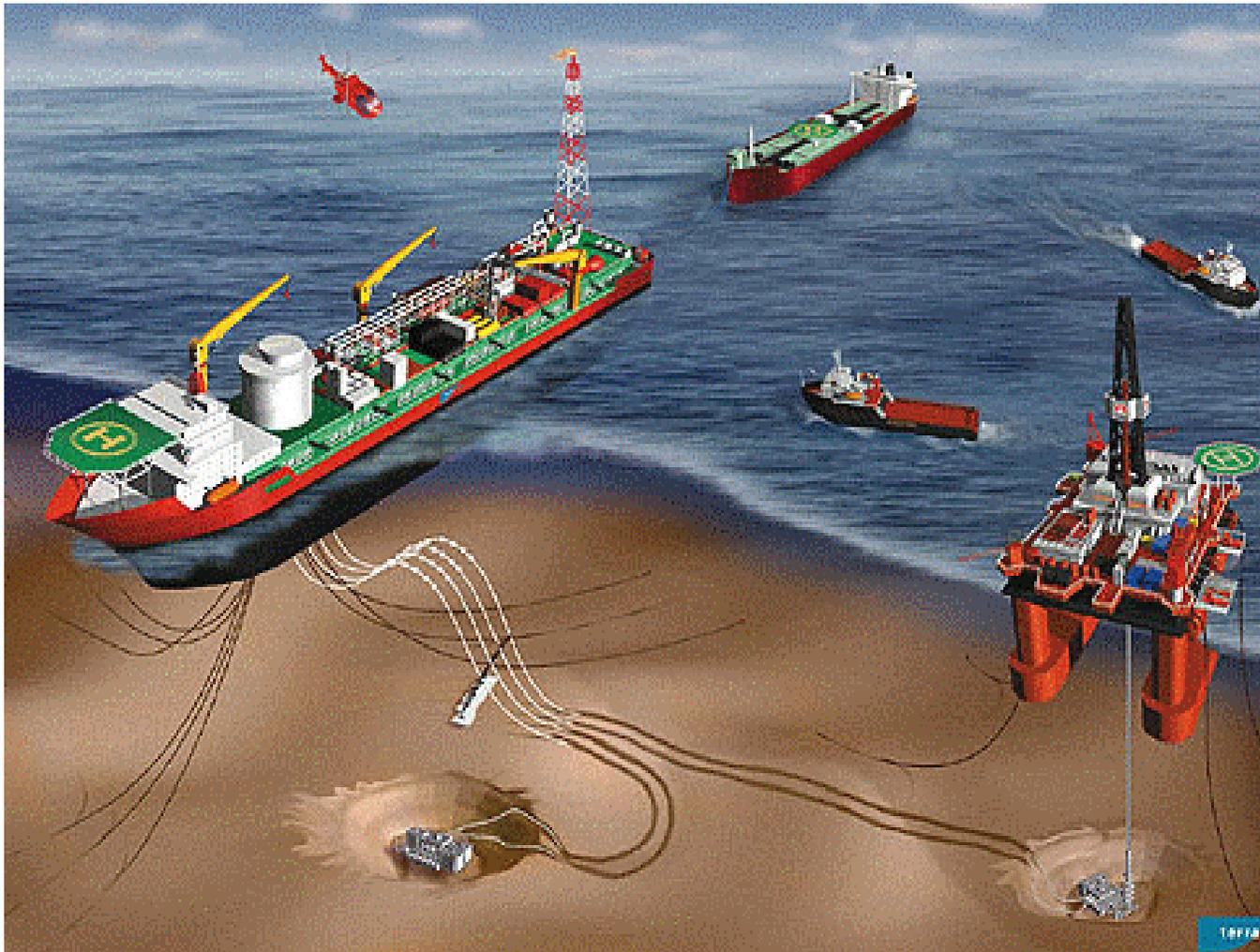
**EXEMPLE DE CONFIGURATION DES INSTALLATIONS SOUS-MARINES ET DE LIAISON ENTRE FOND ET SURFACE**
